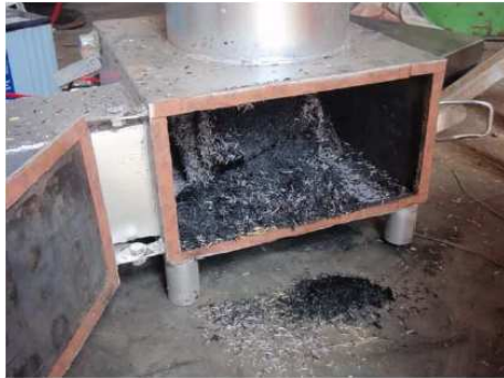
Figure 4 : Evacuation de cendres accumulées en bas du gazogène après chaque test de gazéification
